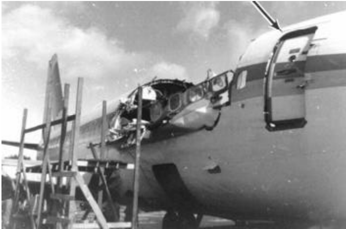
Figuur 2: Vliegtuig waarvan bij gebruik langer dan de oorspronkelijk geplande levensduur een deel van de romp is afgescheurd
